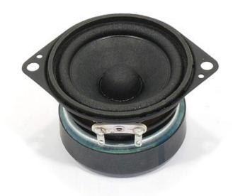
5 cm (2") Breitbandlautsprecher mit schwarzem Korb und zwei Befestigungslaschen. Aufgrund der niedrigen Resonanzfrequenz beginnt der Übertragungsbereich schon bei 120 Hz. Geeignet als Breitbandlautsprecher oder Mitteltöner in Lautsprecherzeilen für HiFi- und Beschallungsanlagen sowie für ELA-Systeme in 100-V-Technik. Durch die geringen Abmessungen auch sehr gut als Kontroll-Lautsprecher in elektronischen Geräten geeignet.
